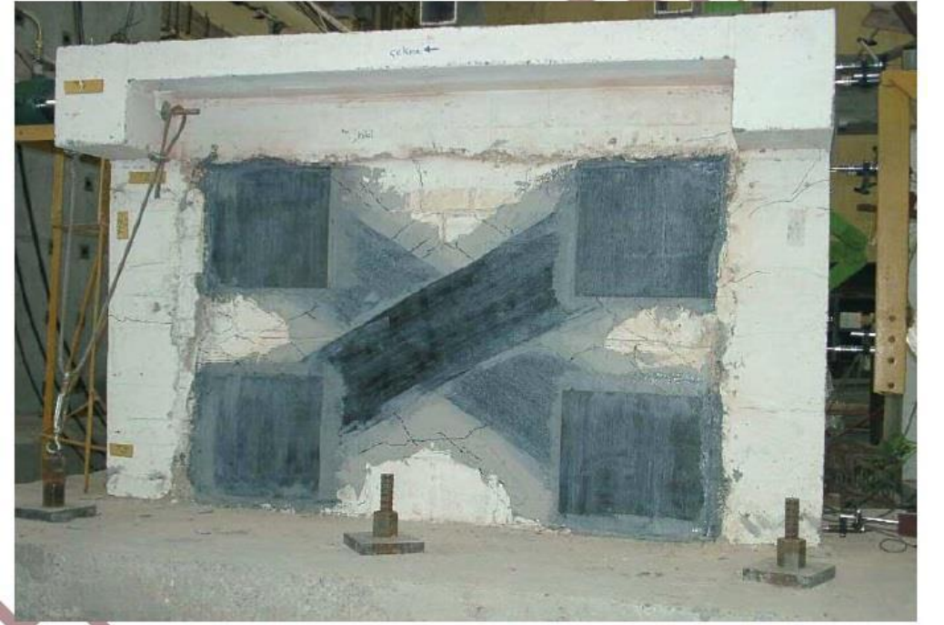
Karbon Fiber Güçlendirme-2019 Deprem Yönetmeliğinde yer almıyor!!!
